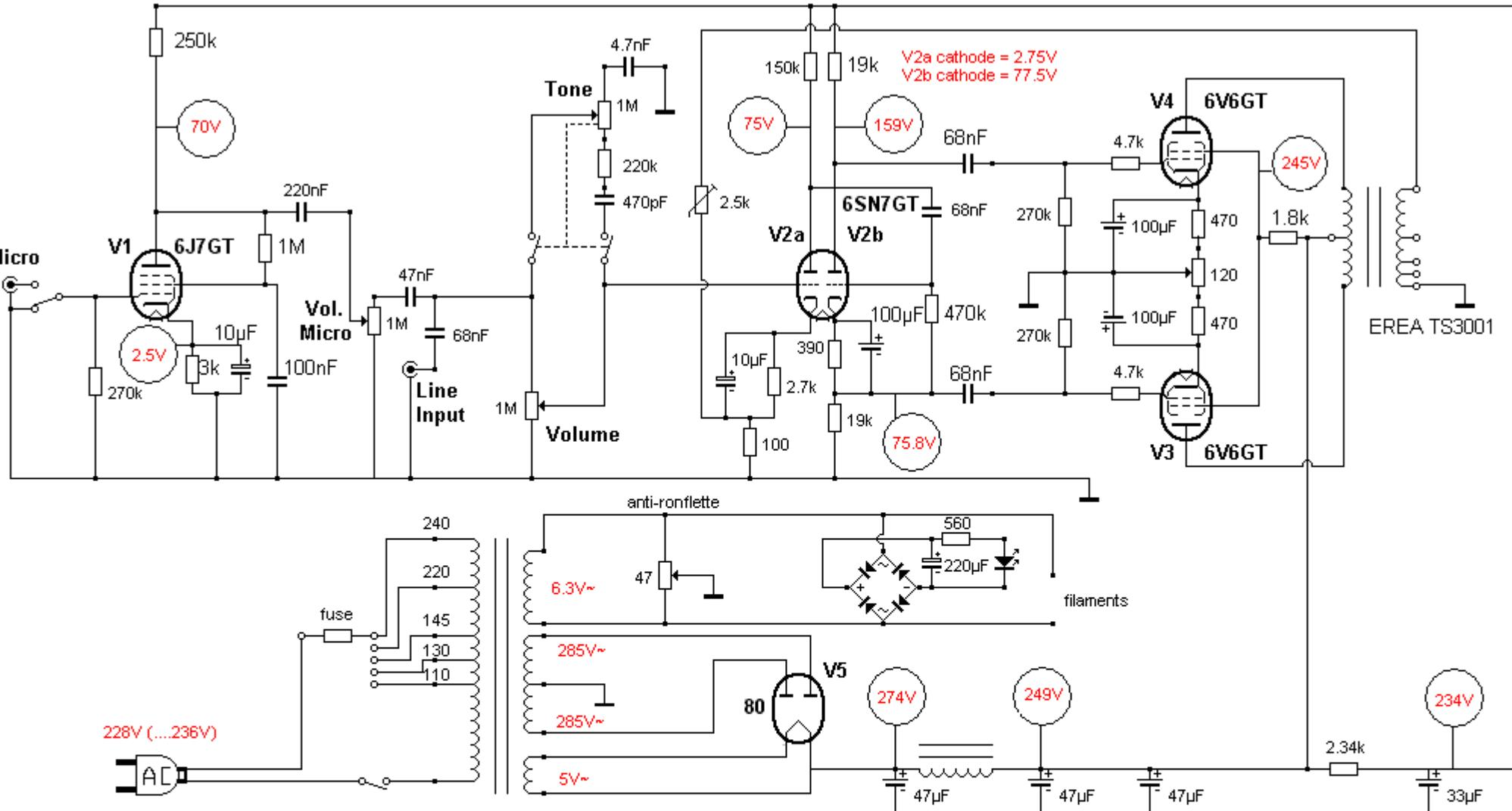
ajouté contrôle tonalité, fiche micro avec switch, branchement transfo sur 240V
