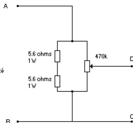
connecter C et D à la place de la résistance de 1 ohm
