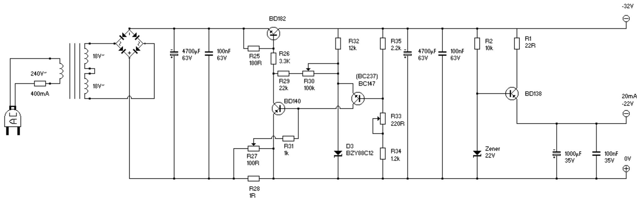
R33 : réglage tension de sortie
