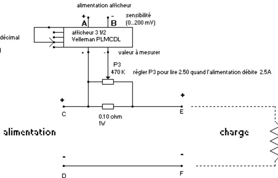
le voltmètre doit être branché entre E et F
