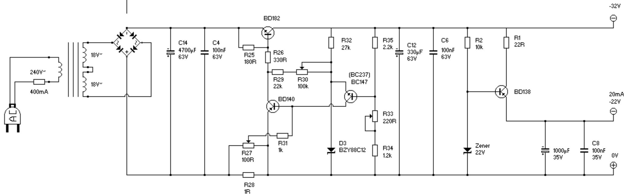
R33 : réglage tension de sortie
