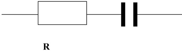
**Schéma équivalent simplifié d'un condensateur**
