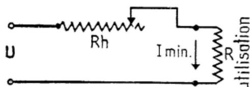
contrôle l'intensité dans le circuit :
