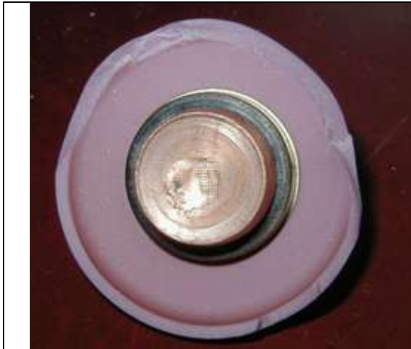
Anode d'une GI-7B. Elle est en cuivre pour mieux répartir et véhiculer la chaleur.
