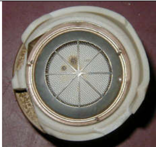
La cathode et la grille. Les deux points noirs sur la cathode sont les traces de l'arc.
