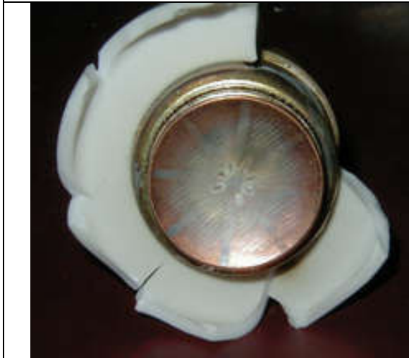
Anode d'une GS-31 (qui a sérieusement flashé).
