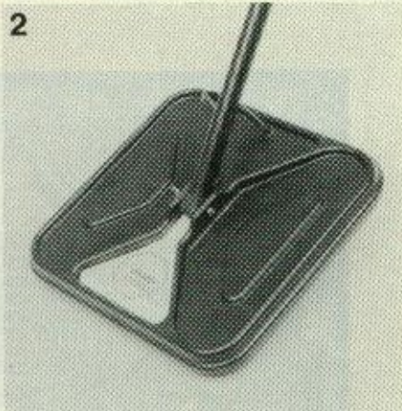
Photo 2. Voici sans doute aucun, la partie la plus importante du détecteur de métaux: la bobine d'exploration.
