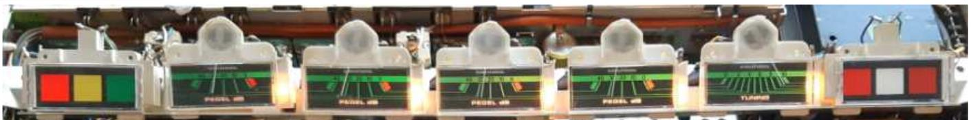
L'indicateur d'accord comme tous les VU-mètres, les voyants et le tunoscope sont raccordés via un toron de fils et un connecteur.
