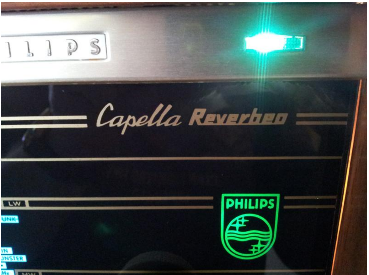
Oben rechts befindet sich das Stereolämpchen. Dieses wird vom Stereodecoder gesteuert und leuchtet automatisch beim Empfang einer Stereosendung auf. Das beleuchtete PHILIPS - Logo darf natürlich auch nicht fehlen.
