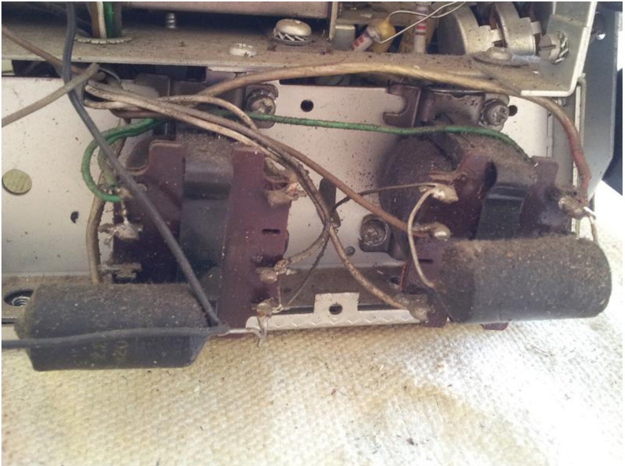
Ce sont les deux transformateurs de sortie sur 800Ω. Il est surprenant qu'ils aient un très petit design.
