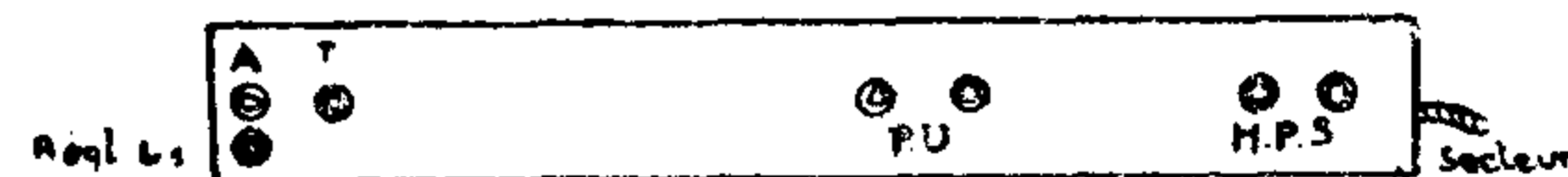
Emplacement des prises « Antenne », « Terre », « Pick-Up » et « Haut-parleur supplémentaire ».
