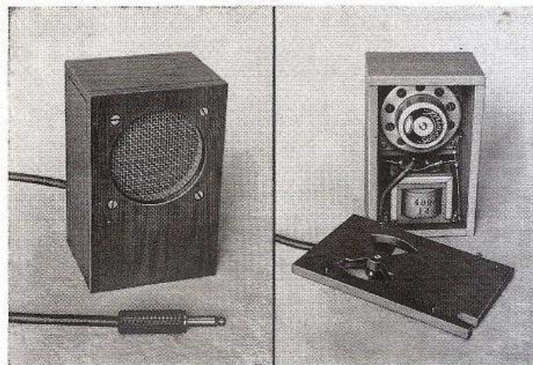
A gauche : un microphone dynamique. — A droite : l'intérieur du microphone dynamique.
